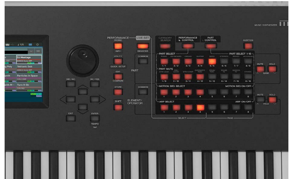
A destra del display troviamo alpha dial, tasti inc/dec, frecce di spostamento che replicano funzioni ottenibili anche da touch screen
